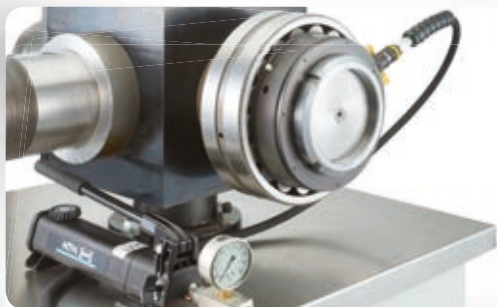
Ściąganie tulei wciąganej za pomocą nakrętki hydraulicznej
